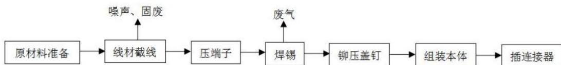
图 4.2 灯具转接器生产工艺流程图
